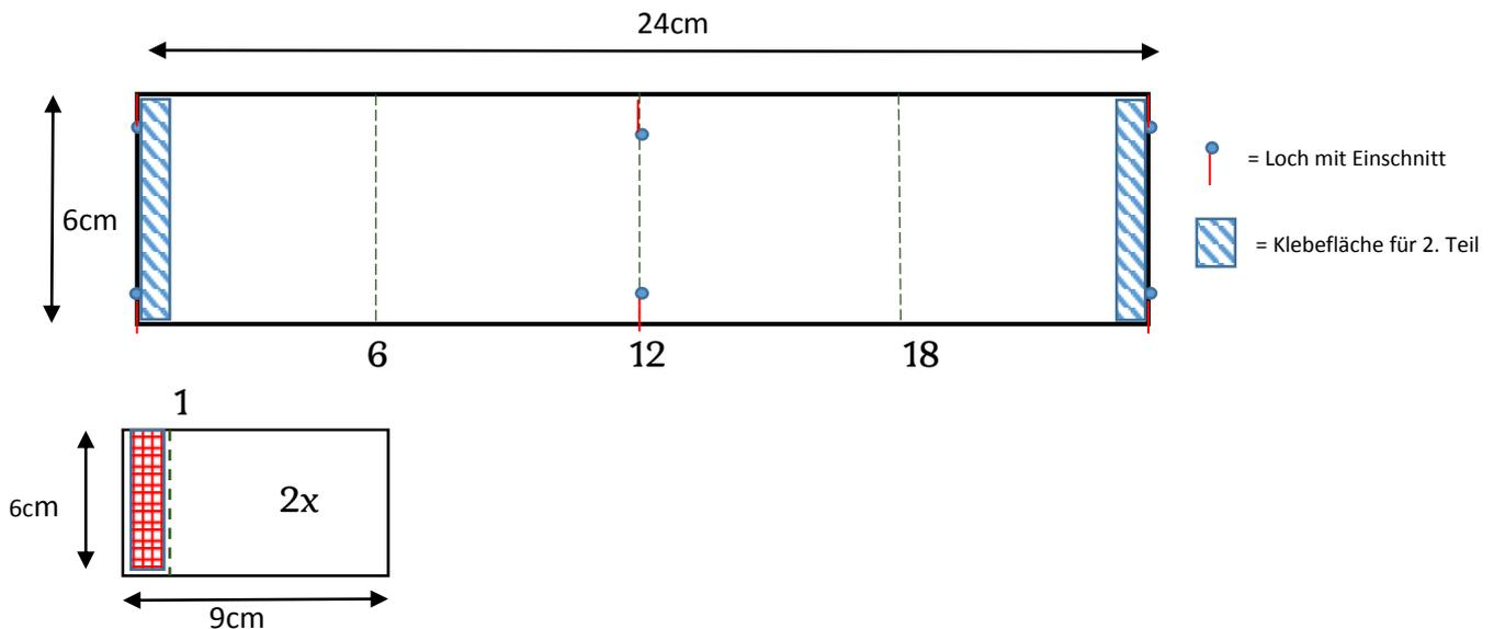
3. Die kurzen Teile nun auf die vorgesehene Klebefläche des langen Teils mit doppelseitigem Klebeband von innen befestigen.
